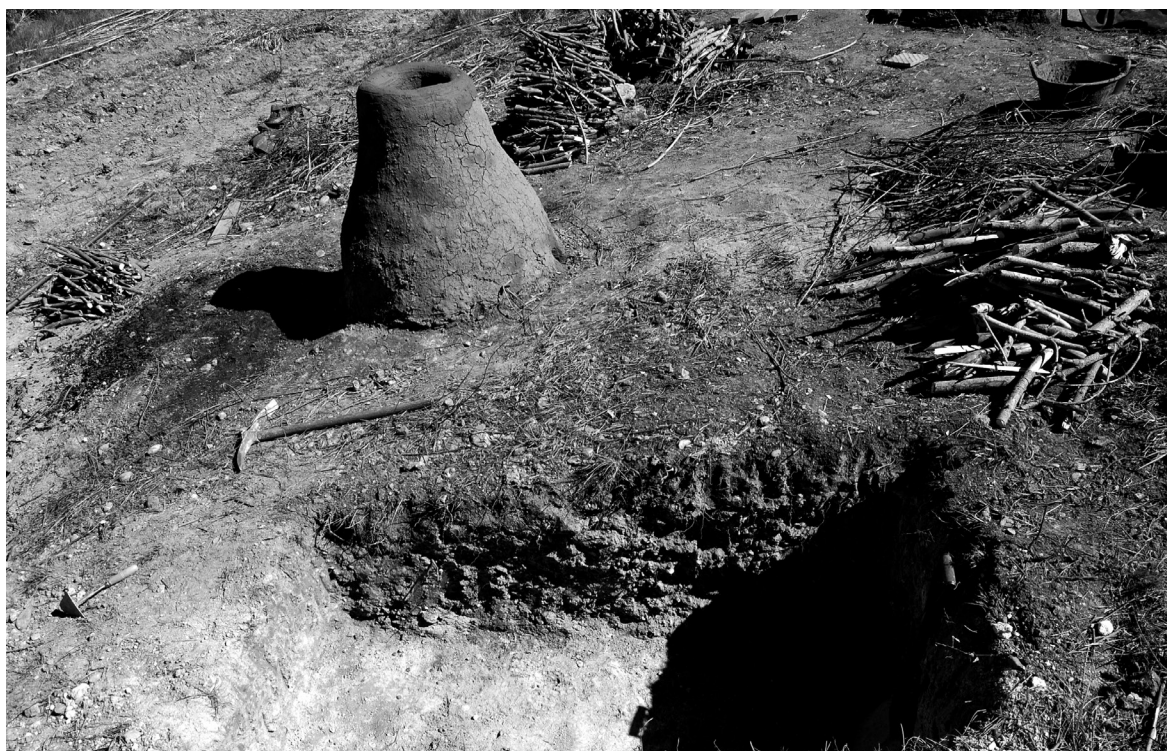
Figura 2. Horno de reducción directa experimental PRELU.
