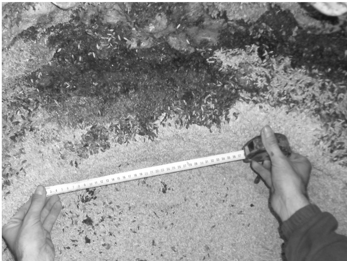
Figura 2. Detall d'una de les zones afectades per la humitat a l'interior de la sitja.
