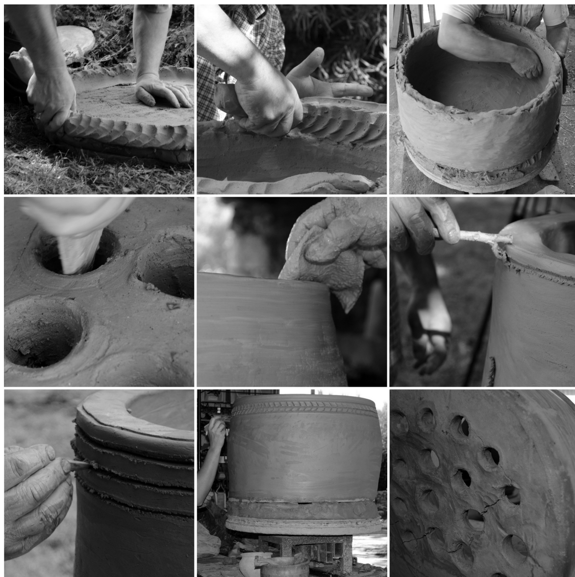
Figura. 4 Secuencia de elaboración de las parrillas. Imágenes combinadas de H1 y H2.
