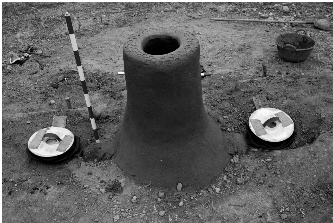
Figura 4. Horno de reducción directa experimental ELSEKON.
