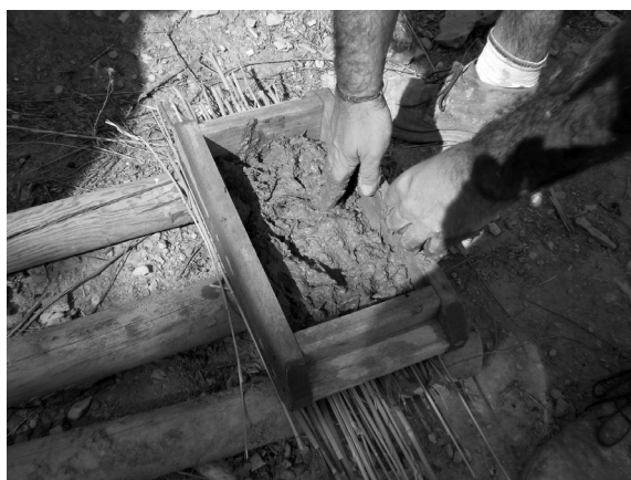
Figura 5. Prova d'empremta de l'argila amb l'espècie Imperata cylindrica , coneguda a la zona com a canya xisca.
